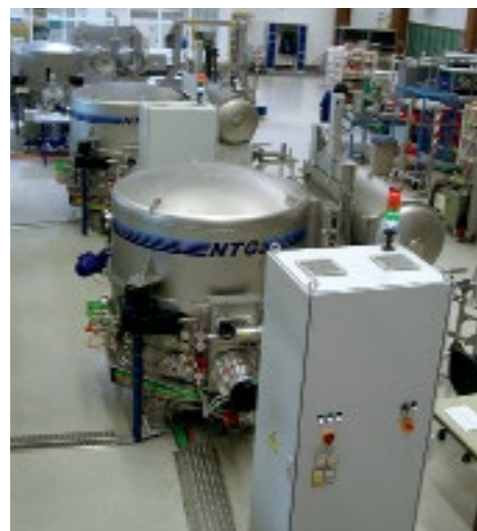
3 IBF 500 Anlagen mit Doppelschleusen
