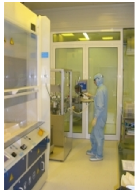
Reinraum mit Anlagen zur chemischen Vor- und Nachbehandlung sowie zur Beschichtung der Substrate und Werkzeuge
